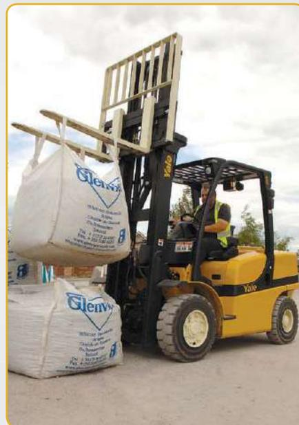
автоматического уменьшения скорости (ADS), которая работает благодаря управляемому приведению в действие пакетов муфт для замедления погрузчика без необходимости выжимания тормозной педали. Система управляемого реверсирования мощности (CPR) уменьшает вращение шин благодаря точному регулированию частоты вращения коленчатого вала двигателя на полной мощности обратного хода, а система контроля отката на наклонной поверхности (CRB) ограничивает откат на склонах до 75 мм в секунду.
